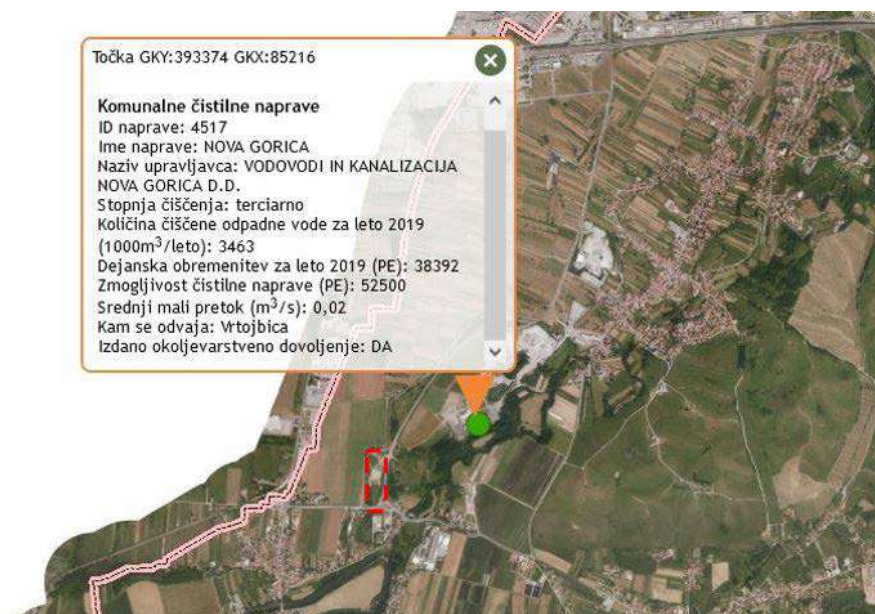
Slika 22: Komunalna čistilna naprava v bližini plana.
